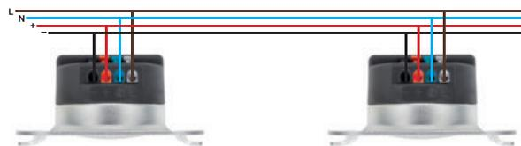
Für eine synchrone Schaltung der Treppenbeleuchtung ist bei der Installation ein 5-adriges Kabel erforderlich. Bei Verdrahtung gemäß Abbildung leuchten alle angeschlossenen Leuchten gleichzeitig.
